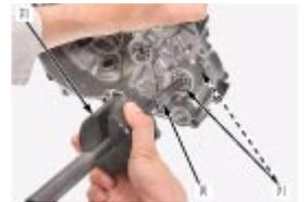
Die Gleitringdichtung [1] und den Öldichtring [2] aus dem rechten Kurbelgehäusedeckel bauen.
