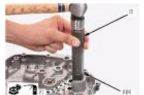
Das Lager nach dem Einbau mit Motoröl schmieren.
